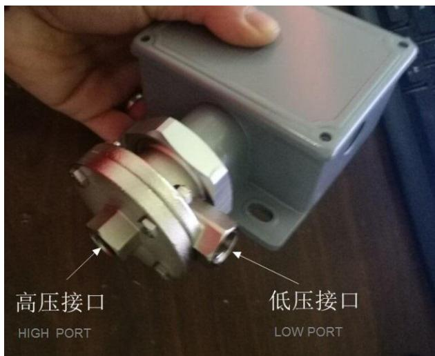
101NN 隔膜式差压控制器采用膜片一活塞组合感应，适合从低到高的差压，流体动力或过程应用中的不同静压，以及过范围的脉冲压力或范围的循环率。可用于空气、气体、油、水等无腐蚀性的介质。 可定制防爆型产品
